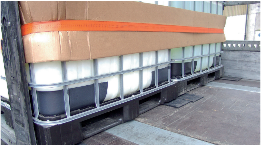
Bild 6.2: Zwischen Ladefläche und FIBC sind Antirutschmatten eingesetzt. Die Mat-ten, Maße 200 × 300 × 10 mm, sind dick genug, so dass die FIBC in der Mitte den Boden nicht berühren.
